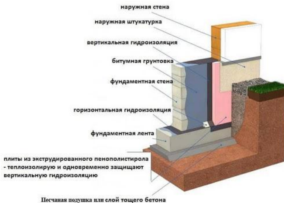
Рис.37. Гидроизоляция фундамента
